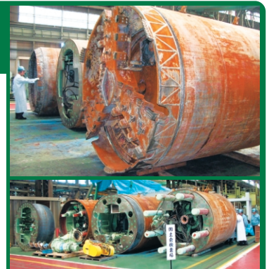
南ルートシールド整備状況
